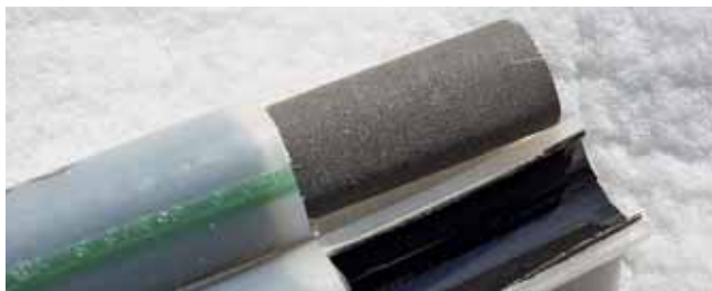
Saniertes «Rohr im Rohr».
