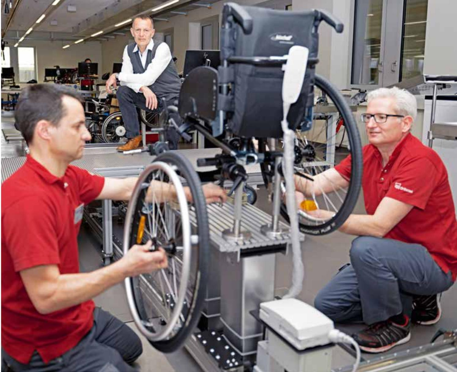
fino a quando non viene raggiunta una posizione ottimale, favorevole per le spalle, si procede con una calibrazione automatica della posizione di seduta», spiega Frieder Wittmann, ricercatore di sistemi sensitivo-motori presso l'ETH.
