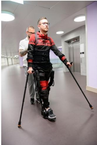
*Abb. 3: Patient beim Training mit dem EksoNR (Ekso Bionics, USA) gesichert durch einen Therapeuten aus der Ekso-Fachgruppe.*
