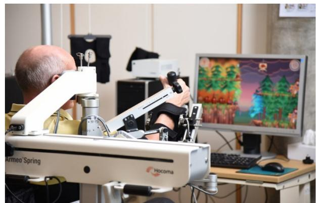
*Abb. 1: Der ArmeoSpring unterstützt die Armbewegung durch Gewichtsentlastung und fördert die Motivation durch spielerisches Training in einer virtuellen Welt.*
